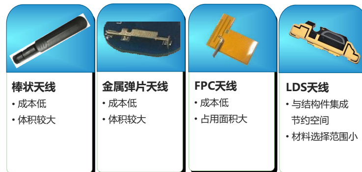
图 5.4 NB-IoT 常用天线类型
