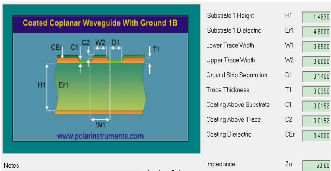
图 5.2 50Ω阻抗的计算方法参考
